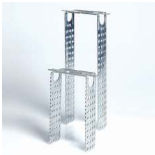
Подвес прямой Предназначен для деревянного каркаса или КНАУФ-профилей ПП 60×27. Длина в смонтирован- ном положении: 120, 200 мм
