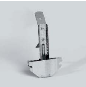
Подвес комбинированный Для КНАУФ-профилей и ПП 60×27. Предназначен для крепления к перекрытию с помощью тяги подвеса или системы Нониус- подвесов. Несущая способность с Нониус-подвесом - 40 кН.
