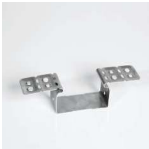
Подвес пружинный Предназначен для крепления в дерево с возможностью нивели- ровки высоты внутрипотолочного пространства до 20 мм.
