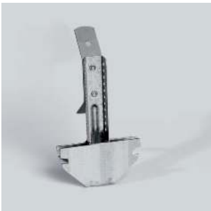
Подвес комбинированный Для КНАУФ-профилей и ПП 60×27. Предназначен для крепления к перекрытию с помощью тяги под- веса или системы Нониус-подвесов. Несущая способность с тягой-25 кН.
