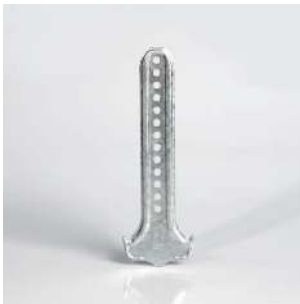
Подвес анкерный Предназначен для крепления КНАУФ-профилей ПП 60×27 к деревянному каркасу.
