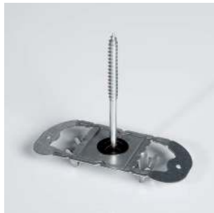
Зажим для крепления КНАУФ-профилей ПП 60×27 Предназначен для крепления в дерево, с возможностью нивели- ровки высоты внутрипотолочного пространства.
