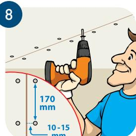
Монтируем KNAUF-листы к каркасу. Шаг крепления не более 170 мм.
