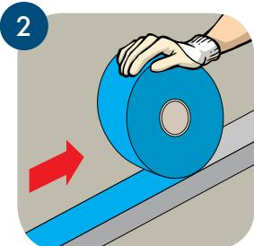
Наносим на наружную поверхность профилей уплотнительную ленту KNAUF.
