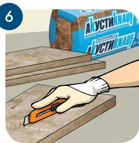
Отмеряем и нарезаем звукоизоляцию АкустиKNAUF. Ширина материала на 10 мм больше шага каркаса.
