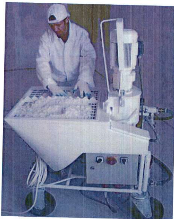
Рисунок 21 – Приготовление штукатурной смеси с помощью штукатурной станции
