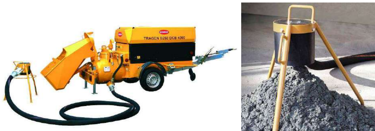
Рисунок 19 – Подача смеси к месту укладки с помощью растворонасоса
