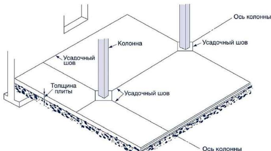
**Рисунок 25** – Ориентировочная схема устройства деформационных швов
