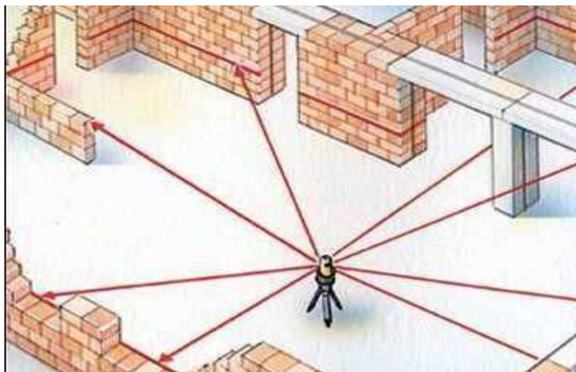
**Рисунок 8** – Вынос отметок с помощью лазерного нивелира
