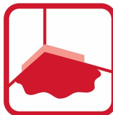
Для нанесения мастики в таких местах как внешние и внутренние углы, в местах пропуска коммуникаций, в местах деформационных швов рекомендуется использовать герметизирующий уплотняющий материал (гидроизоляционная лента, манжета и уголки).
